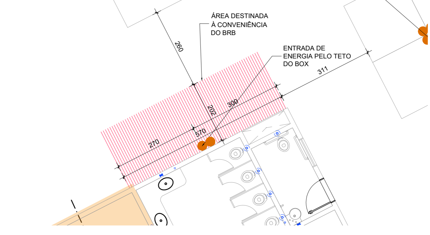
PLANTA ESQUEMÁTICA DE ENTRADA DE ENERGIA NA CONVENIÊNCIA DO BRB ESC. 1:75
