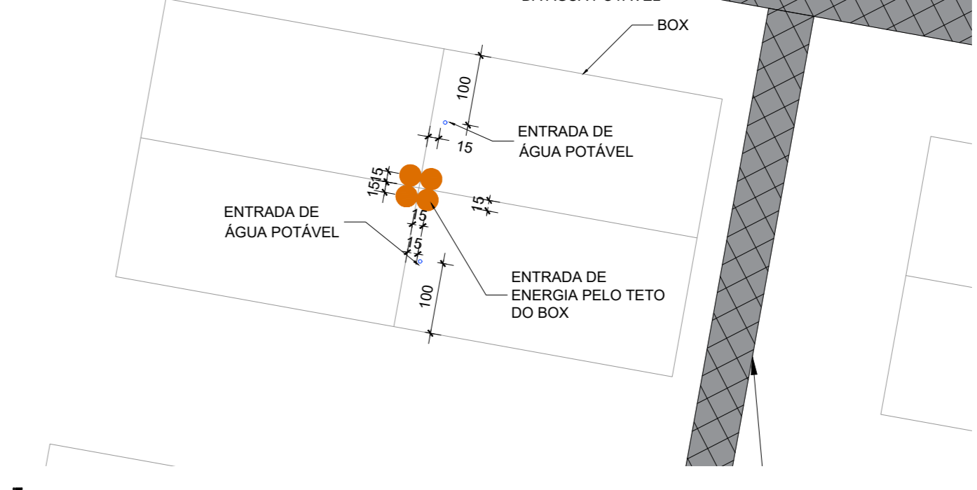
PLANTA ESQUEMÁTICA DE ENTRADA DE ÁGUA E ENERGIA NO BOX ESC. 1:75
